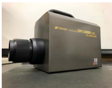
図 3.2.1. ハイパースペクトルカメラ (SR-5000HS) の外観および仕様
